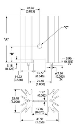
A Dim **50.80**B Dim **18.29**C Dim **3.17**
