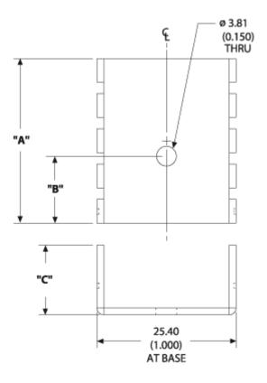
A Dim **29.97** B Dim **11.68** C Dim **12.70**
