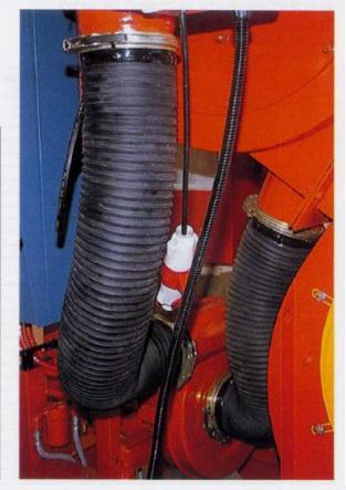
Superficie interna praticamente liscia. Ottima flessibilità. Temperatura: -25° C +125° C. Ottima resistenza agli olii.
