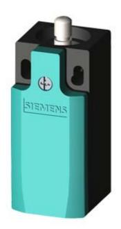
. PLASTIC HOUSING ACC. TO EN50047, 31MM DEVICE CONNECTION 1X(M20X1.5); 1NO/2NC SLOW-ACTION CONTACTS TEFLON PLUNGER
