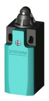
SIRIUS POSITION SWITCH; PLASTIC HOUSING ACC. TO EN50047, 31MM DEVICE CONNECTION 1X(M20X1.5); 1NO/2NC SLOW-ACTION CONTACTS ROLLER PLUNGER W. PLASTIC ROLLER 10MM
