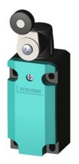
SIRIUS POSITION SWITCH PLASTIC ENCLOSURE 40MM, TWIST LEVER, TO EN50041, DEVICE CONNECTION 1X (M20X1.5) 1NO/1NC SLOW-ACTION CONTACTS PART-TURN ACTUATOR RIGHT/LEFT ADJUSTABLE, METAL LEVER 27MM LONG AND PLASTIC ROLLER 19MM
