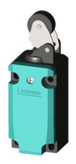
SIRIUS POSITION SWITCH METAL ENCLOSURE 40MM ACC. TO EN50041 DEVICE CONNECTION 1X (M20X1.5) 1NO/1NC SNAP-ACTION CONTACTS METAL ROLLER LEVER AND PLASTIC ROLLER 22MM
