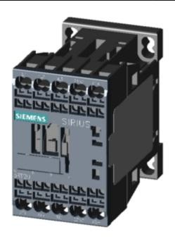
CONTACTOR, AC-3, 4KW/400V, 1NC, DC 24V, 3-POLE, SZ S00 SPRING-LOADED TERMINAL
