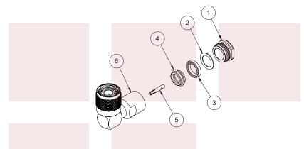
1. SLIDE CLAMP NUT ①, THIN-WASHER ② & GASKET ③ OVER CABLE. STRIP CABLE AS SHOWN. DO NOT NICK BRAID WHILE CUTTING JACKET. TAPER END OF BRAID TO PERMIT ASSEMBLY OF CLAMP.
