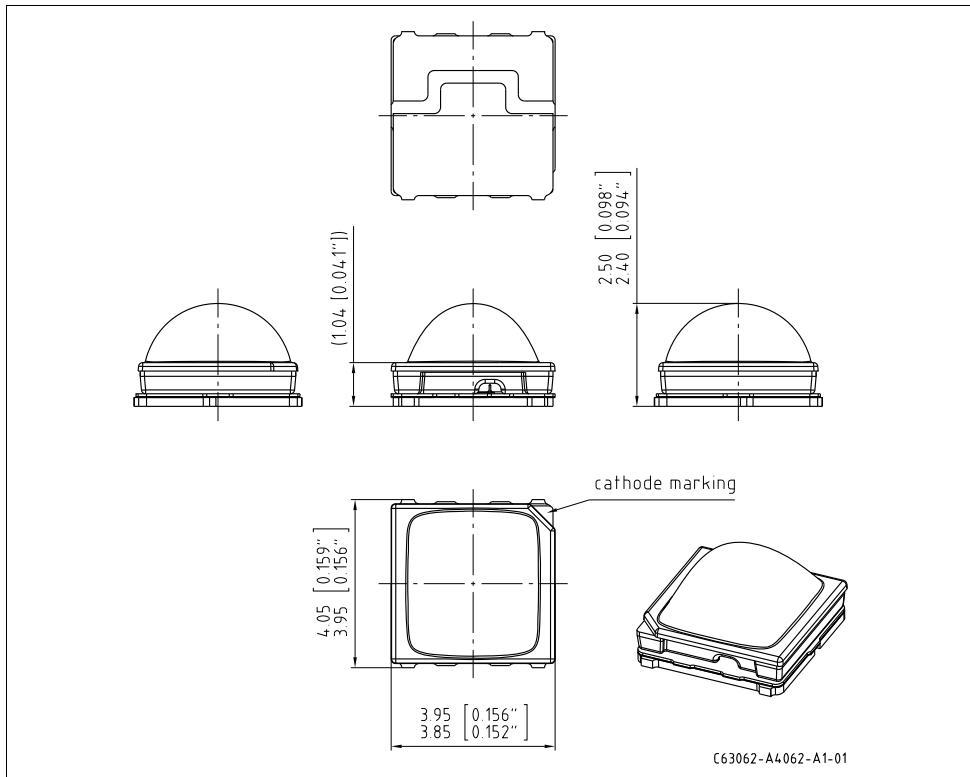
Anm.: Die LED enthält ein ESD-Bauteil, das parallel zum Chip geschalten ist.
